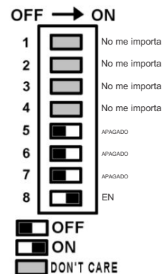
Vista de cerca del interruptor DIP configurado para el modo de calibración
