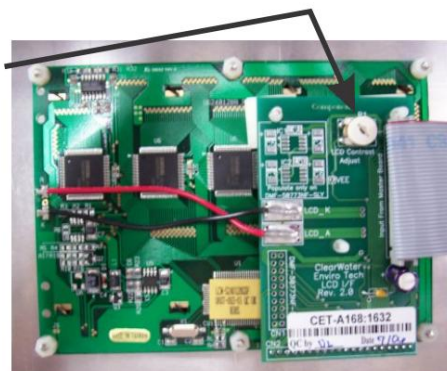
Parte posterior de la pantalla LCD que muestra el control de contraste
