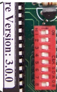
Vista de cerca del interruptor DIP configurado para el modo de calibración
