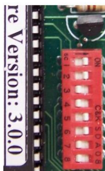
Vue du commutateur Dip réglé pour le mode normal.
