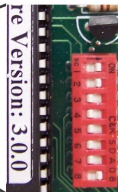
Vue rapprochée du commutateur DIP réglé pour le mode d'étalonnage
