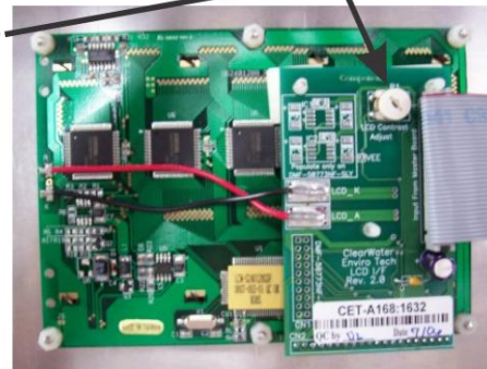
Face arrière de l'écran LCD affichant le contrôle du contraste
