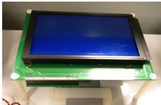
À l'intérieur de l'unité montrant l'écran LCD
