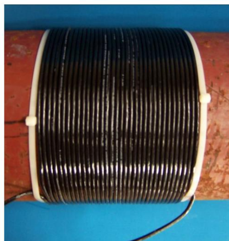
Photo 4a et 4b - Exemples de fils de signal enroulés serrés
