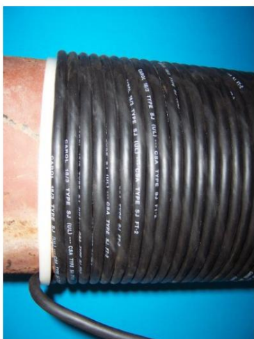
Photo 4a et 4b - Exemples de fils de signal enroulés serrés
